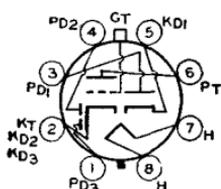
**TRIPLE DIODE—HIGH-MU TRIODE**
