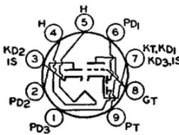
**TRIPLE DIODE-HIGH-MU TRIODE**
