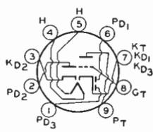
**TRIPLE DIODE—HIGH-MU TRIODE**
