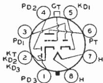
**TRIPLE DIODE—HIGH-MU TRIODE**
