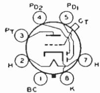
**TRIPLE DIODE—HIGH-MU TRIODE**
