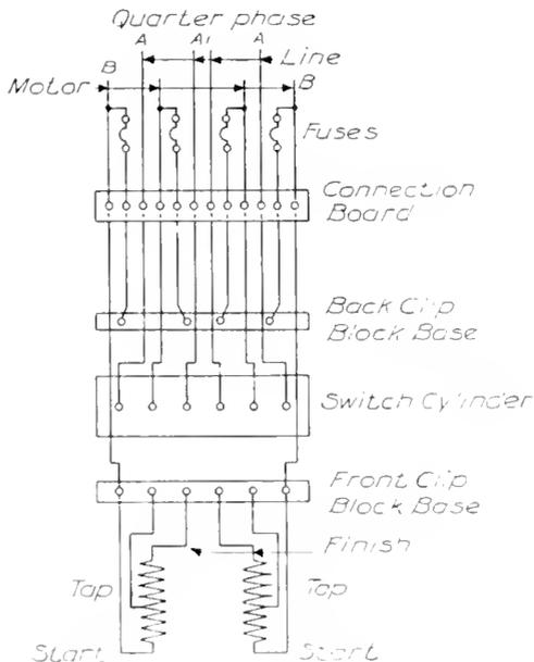
Fig. 76. Quarter-Phase Compensator
