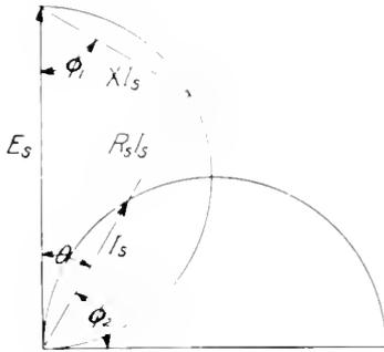
Fig. 13. Fundamental Circle Diagram
