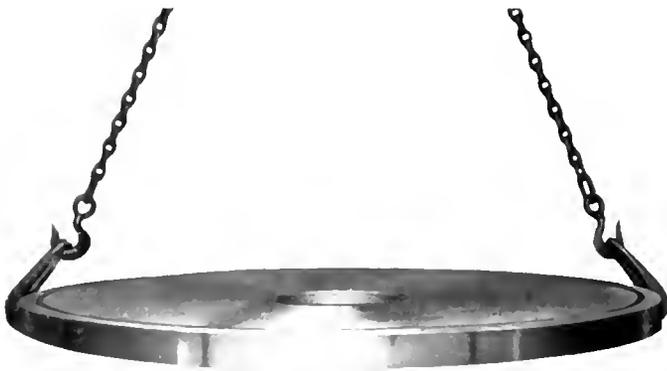
Fig. 25. Two Double Hooks
