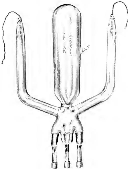
Fig. 11. Constant Current Rectifier
