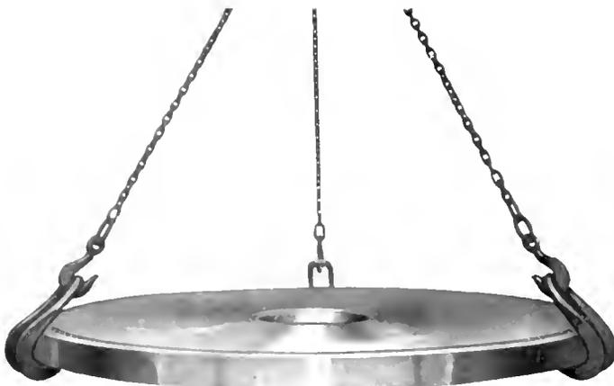
Fig. 26. Three Double Hooks
