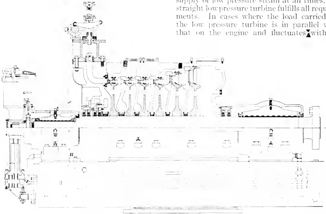
Fig. 1. A Six-Stage Impulse Turbine
