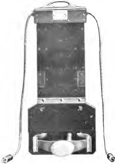
Fig. 23. Underground Conduit Plow Collector
