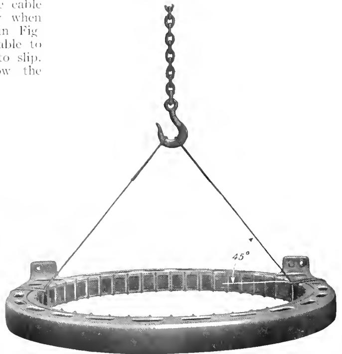
Fig. 28. 45 Deg. Angle Sling (Right Way)
