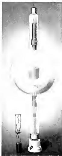
Fig. 41. High-voltage Kenotron.
