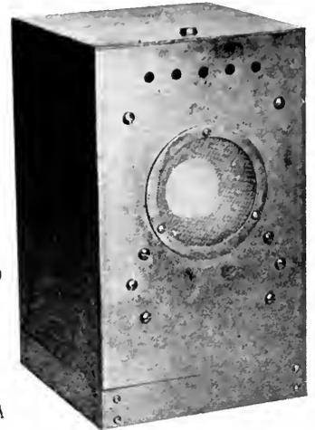
Fig. 20. Condenser Microphone
