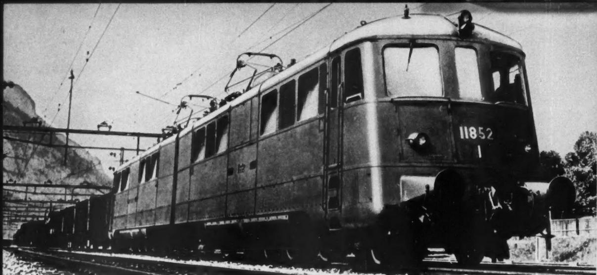
POWERFUL CFF ELECTRIC HAULS A STRING OF BOX CARS ON ONE OF SWITZERLAND'S MAINLINES UNDER 15,000-VOLT A-C POWER
