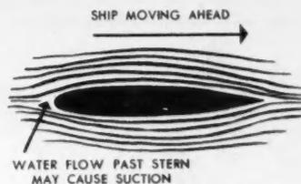
FIG. 3. FLOW PATHS AROUND THE SHIP
