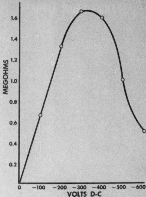
FIG. 2. RESISTANCE OF THE G10 GERMANIUM POWER RECTIFIER
