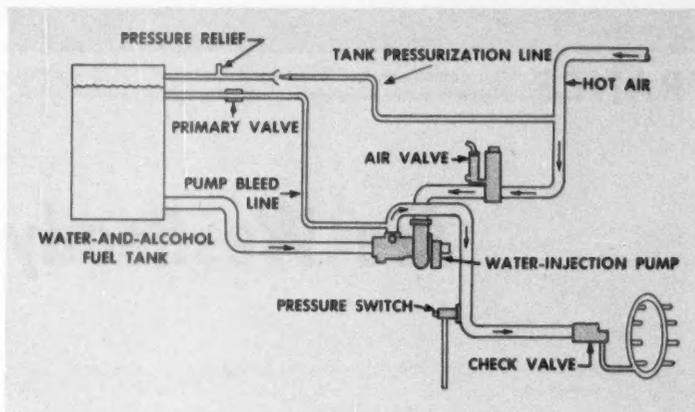
LIQUID INJECTION INTO COMBUSTION BURNER BEGAN WITH THE LOW-FLOW SYSTEM
