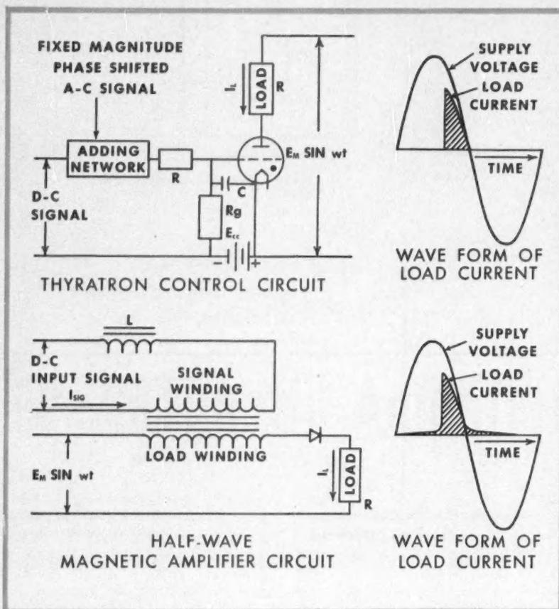
COMPARISON OF THE THYRATRON AND HALF-WAVE MAGNETIC AMPLIFIER CIRCUITS.
