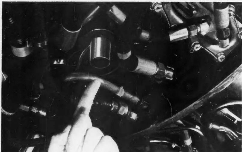
HIGH-TEMPERATURE ACCELEROMETER OPERATES IN AMBIENT TEMPERATURES OF  $-50$  TO  $+500$  F.
