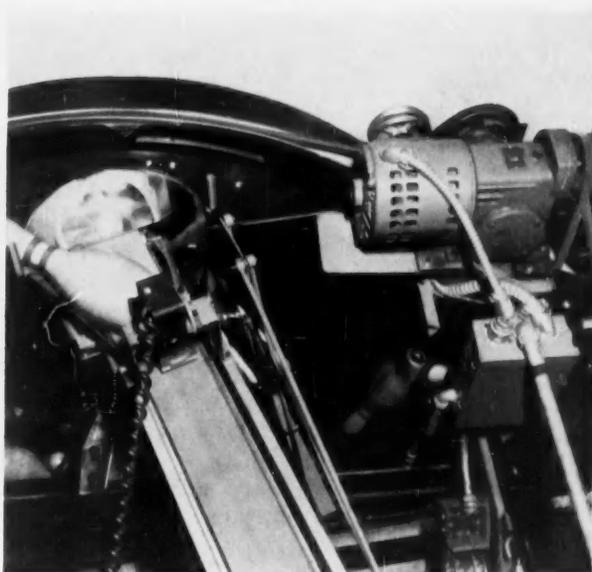
**NEW MULTISHAFT GEAR-MOTORS OPERATE AUTOMATIC PIN SPOTTER.**
