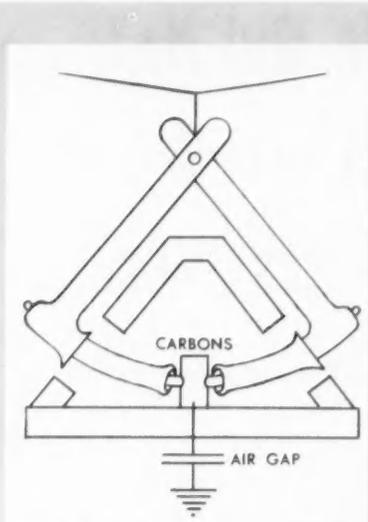
FIG. 4. PICKAX LIGHTNING ARRESTER
