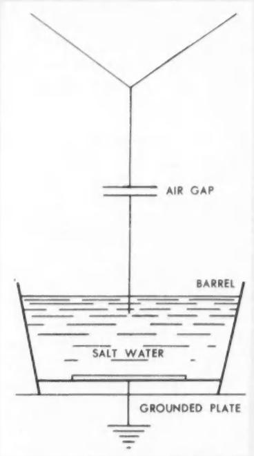
FIG. 6. TUB LIGHTNING ARRESTER
