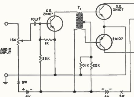
FIG. 6E. LOUDSPEAKER AUDIO AMPLIFIER
