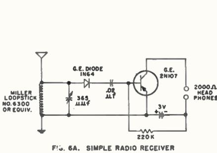
FIG. 6A. SIMPLE RADIO RECEIVER
