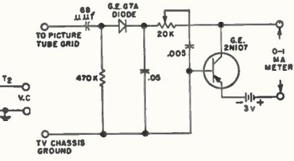
FIG. 6F. TV ANTENNA ORIENTATION METER
