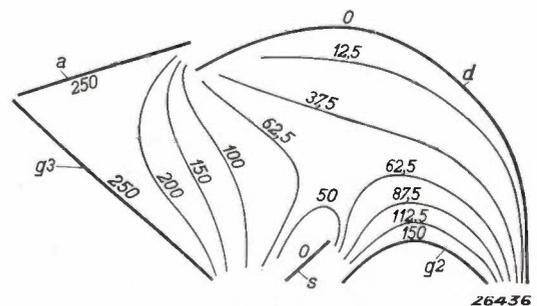
Fig. 11. Curvature of equipotential planes in valve 4696.
