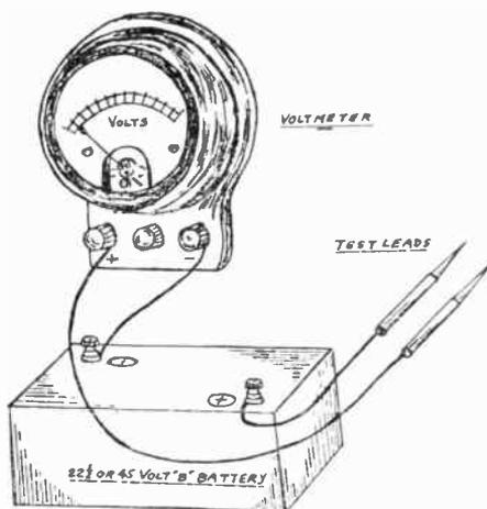
Fig. 1—Voltmeter Testing Outfit.
