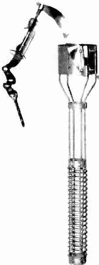
FIG. 14 - GRID CONSTRUCTION
