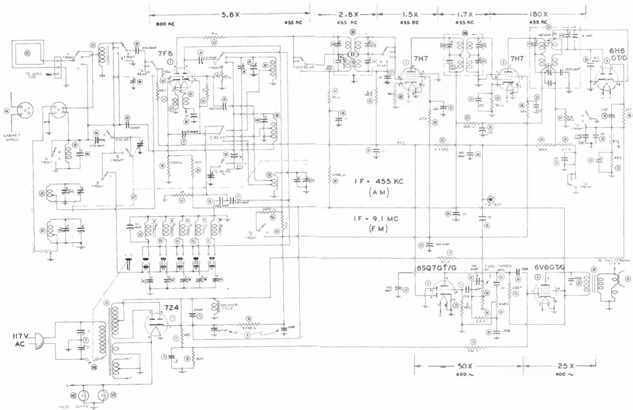
VOLTAGE AND RESISTANCE READINGS TAKEN IN BROADCAST POSITION
