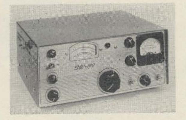
130 watts PEP input to 6DQ5 Power Amplifier.
