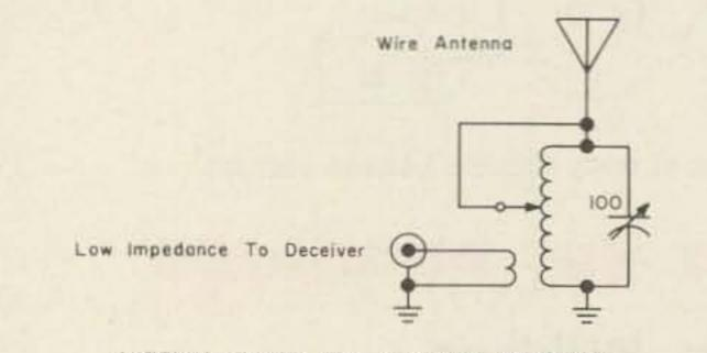
ANTENNA TUNER FOR RECEIVER DECEIVER
