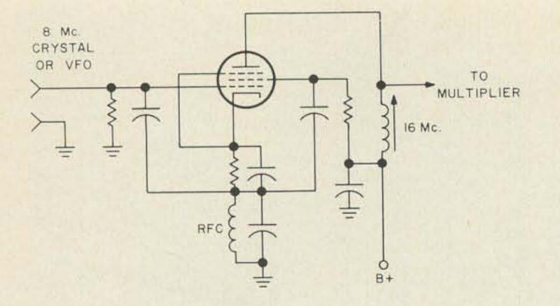
FIGURE 2 OSCILLATOR IN TRANSMITTER
