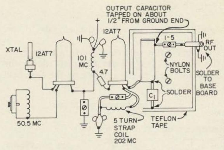
FIG.2 GENERAL LAYOUT, TOP VIEW, 404 MC LOCAL OSCILLATOR CHAIN
