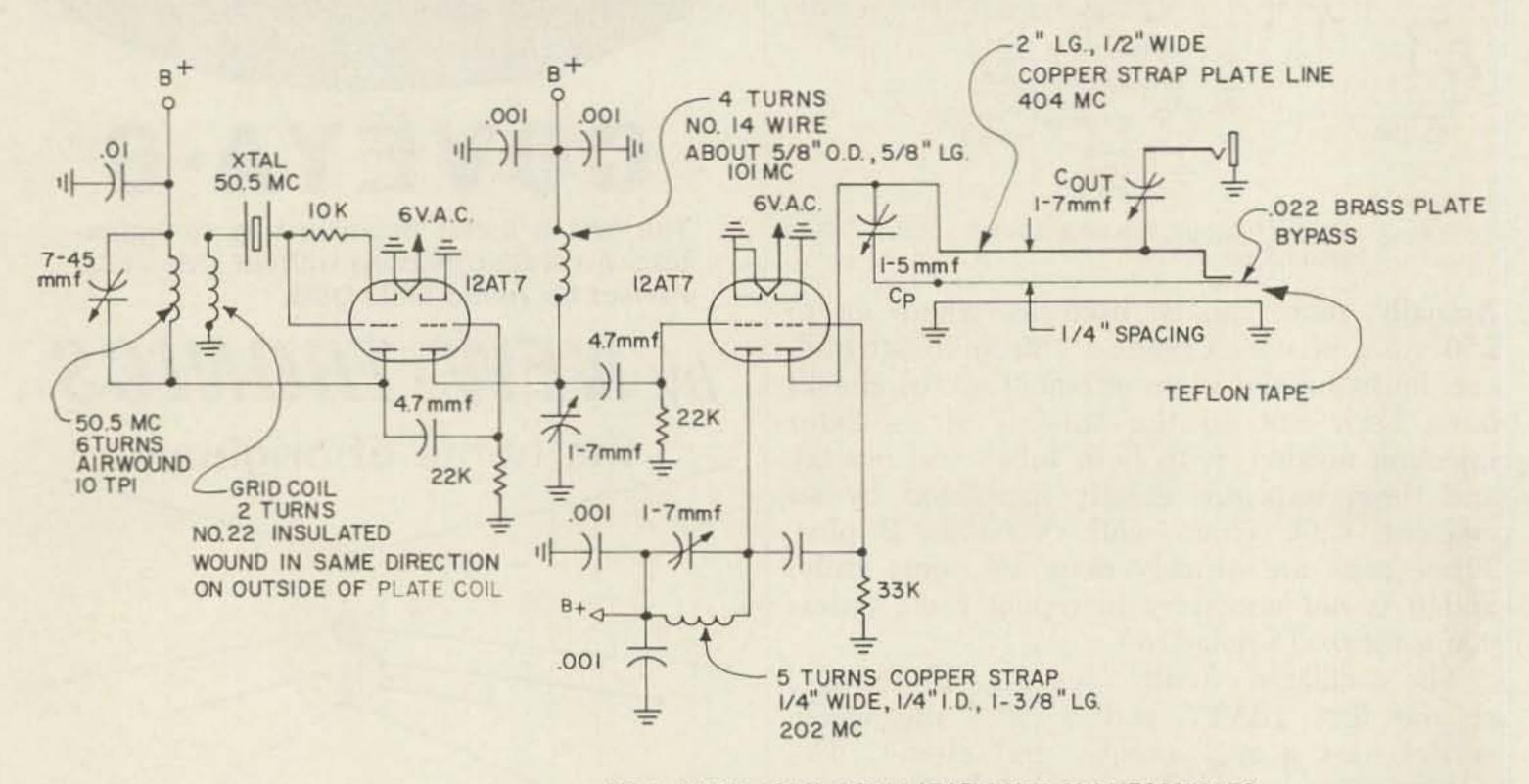
FIG. 1 12AT7 LOCAL OSCILLATOR CHAIN, 404 MEGACYCLES
