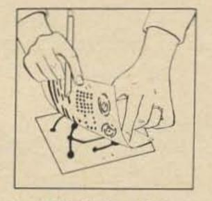
2. PEEL BACK ... LEAVING ETCH RESIST ON COPPER SURFACE
