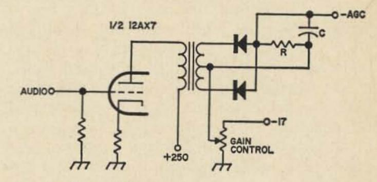
Fig. 7. The AGC circuit.
