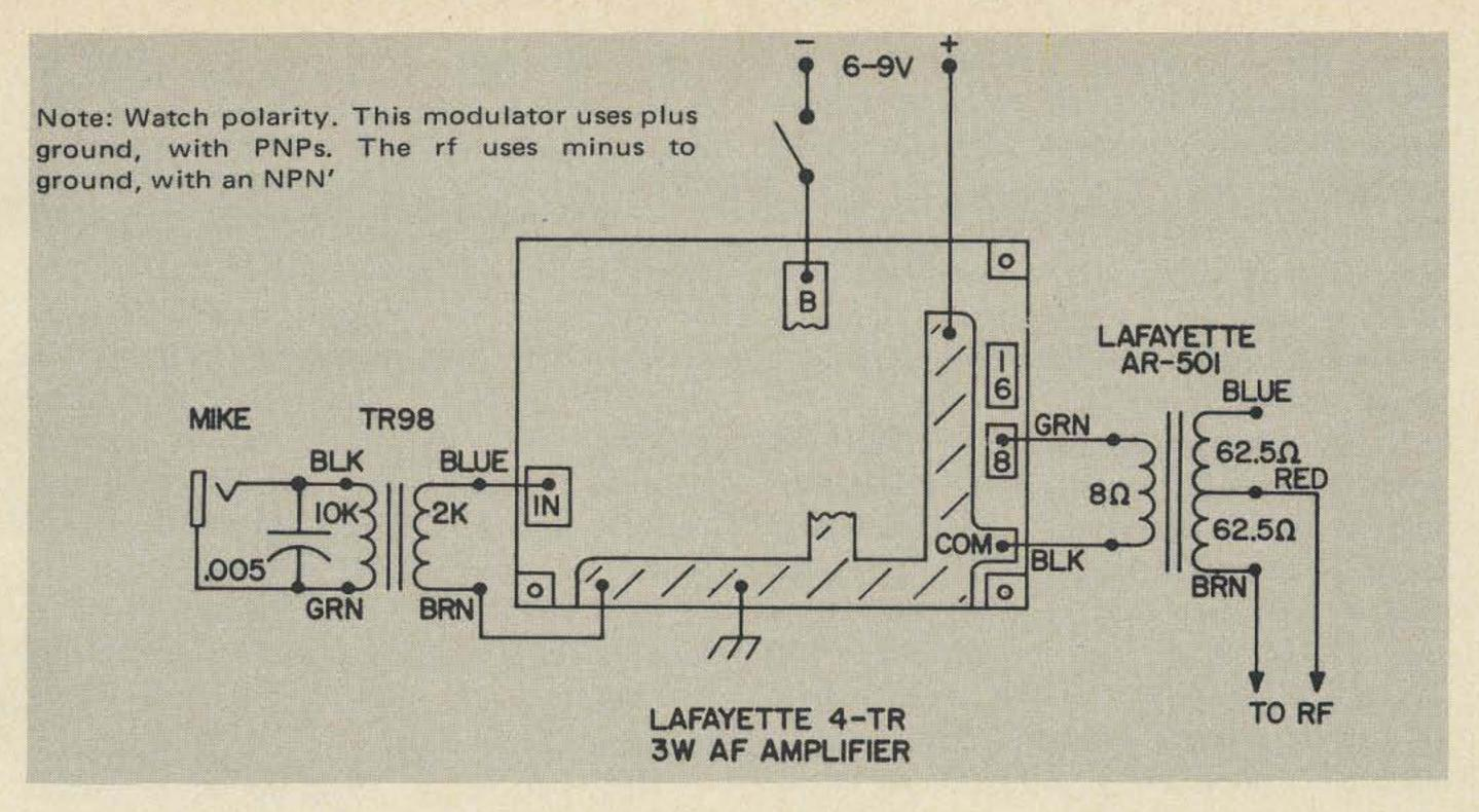
Fig. 4. Modulator circuit, 2 watt, 6 meter rig.
