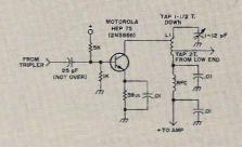
Fig. 30. 73 MHz doubler schematic
