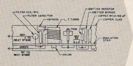
Fig. 29. 24 MHz tripler wiring diagram.
