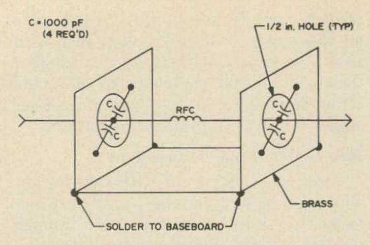
Fig. 4. Brass frame module.
