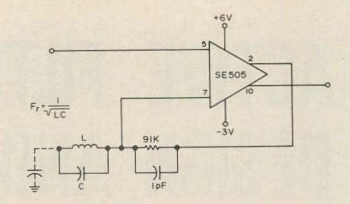
Fig. 6. Band reject amplifier.
