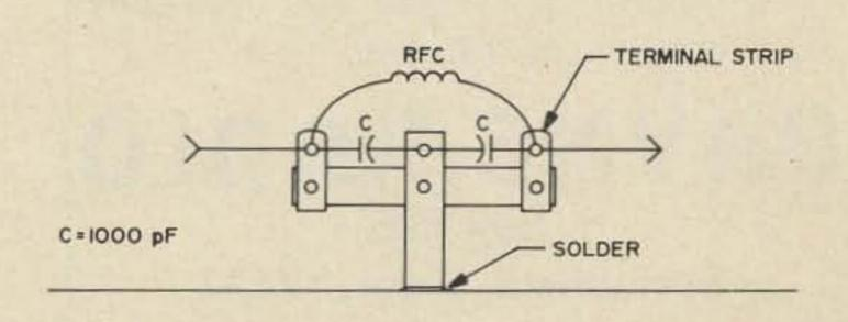
Fig. 3. Filter module.
