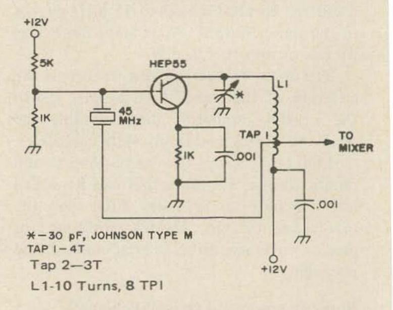
Fig. 3. Crystal oscillator, 45 MHz.
