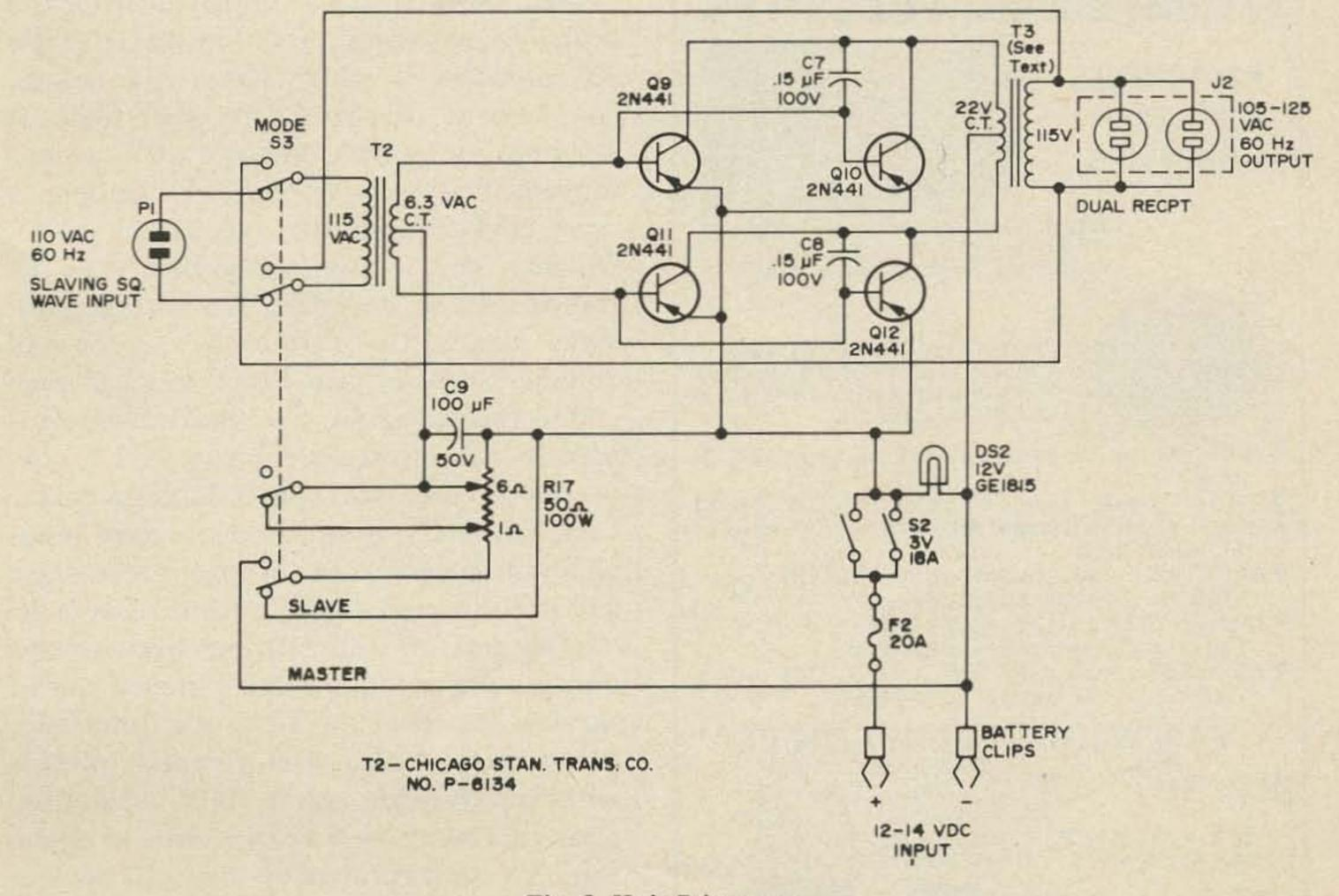
Fig. 2. Unit B inverter.
