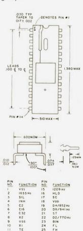
Fig. 8. DTMF detector (CRC 8030).
