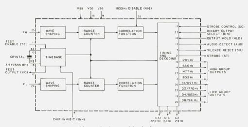
Fig. 1. CRC 8030 block diagram.
