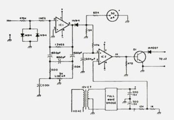
Fig. 4. IC1, IC2-741 op amps; Q1-MJE-340.
