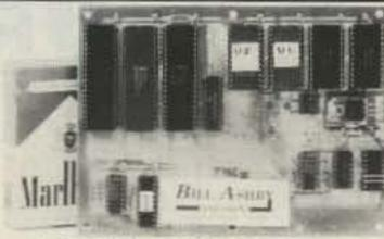
ASCII—USA/AX.25 HDLC CONVERTER
