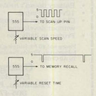
Fig. 1. Simple scan reset.
