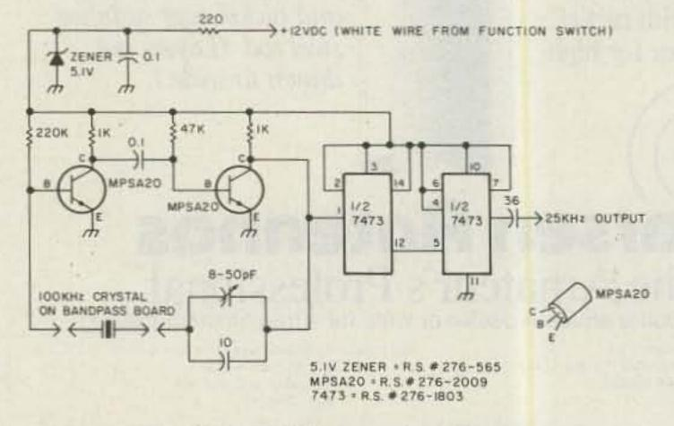
Fig. 1(a). 25-kHz crystal calibrator.
