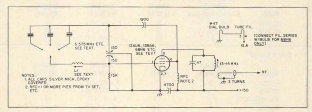
Fig. 1. The vxo circuit.
