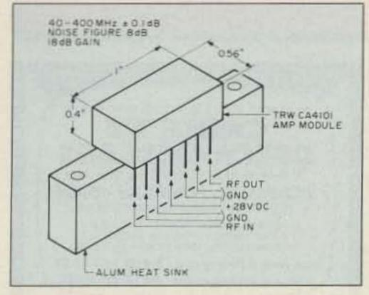
Figure 4. TRW CATV amplifier module.
