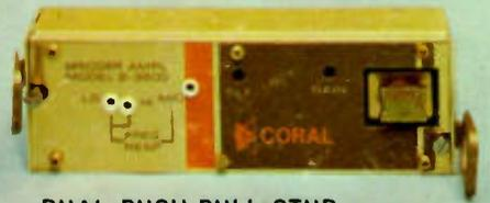
DUAL PUSH-PULL STUD TRANSISTOR AMPLIFIER FOR HIGHER OUTPUT
