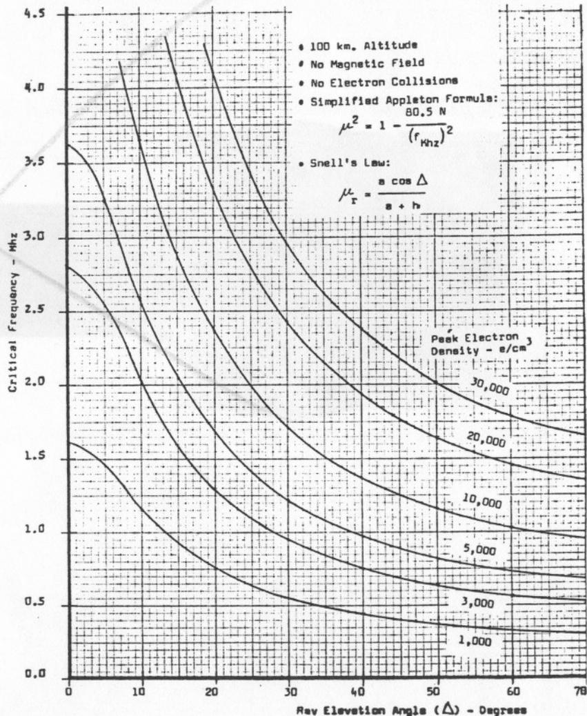
FIGURE 1. OBLIQUE RADIO WAVE E-REGION CRITICAL FREQUENCIES
