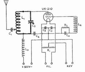
THE CIRCUIT OF THE SINGLE-CONTROL TRANSMITTER
