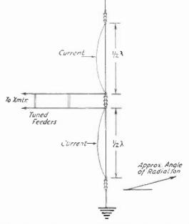
A SIMPLE VERTICAL ANTENNA SYSTEM FOR LOW-ANGLE RADIATION
