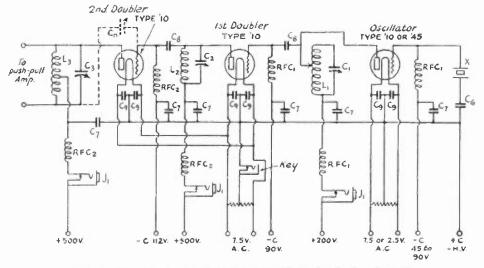
THE OSCILLATOR AND FREQUENCY-DOUBLER CIRCUIT
