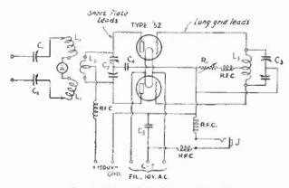
THE PUSH-PULL TRANSMITTER CIRCUIT
