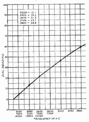
TYPICAL CALIBRATION CURVE FOR THE FREQUENCY METER
