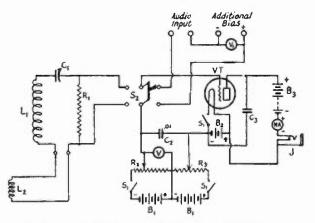
SCHEMATIC CIRCUIT OF THE MODULOMETER
