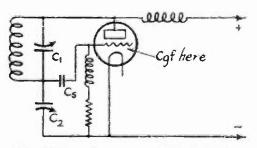
A SHUNT-FEED ULTRAUDION CIRCUIT
