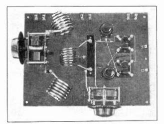
PLAN VIEW OF THE LOW-POWER PUSH-PULL AMPLIFIER
