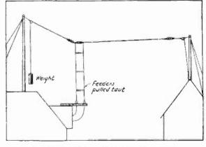
A TYPICAL EXAMPLE OF GOOD ANTENNA CONSTRUCTION
