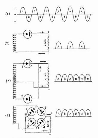
FUNDAMENTAL RECTIFIER CIRCUITS
