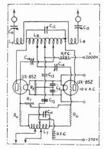
THE 150-WATT PUSH-PULL AMPLIFIER CIRCUIT
