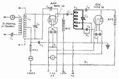
THE CIRCUIT OF THE OSCILLATOR-AMPLIFIER TRANS-MITTER
