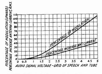
MODULOMETER PERFORMANCE CURVES OF A 'PHONE TRANSMITTER
