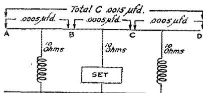
FIG. 1— HOW THE MULTIPLE-TUNED ANTENNA OPERATES
