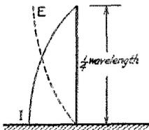
FIG. 1 VERTICAL ANTENNA
