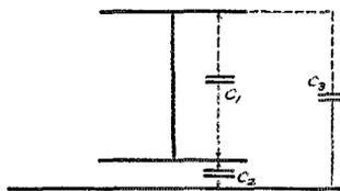
FIG. 5 - DISTRIBUTION OF CAPACITIES OF SYSTEM SHOWN IN FIG. 4
