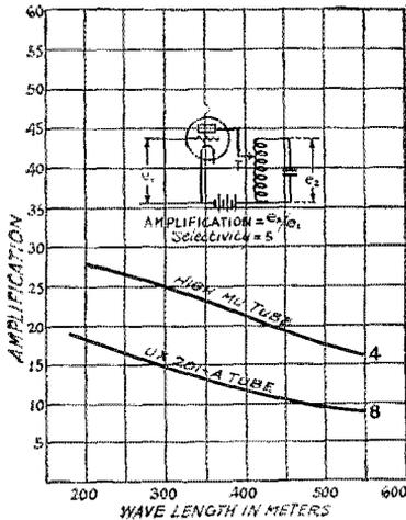
FIG. 2. REPEATER AMPLIFICATION FOR TRIODES
