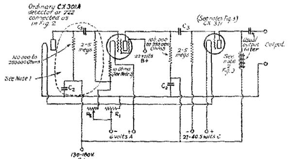
**FIG. 4. THE SHIELD-GRID METHOD OF USING THE TUBE AS AN AUDIO AMPLIFIER**
