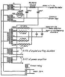
FIG. 2. - THE POWER SUPPLY CIRCUIT
