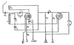
FIG. 2. — W1AQD'S SCREEN GRID DETECTOR CIRCUIT
