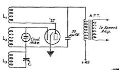
FIG. 1—CONDENSER MICROPHONE OSCILLATOR CIRCUIT
