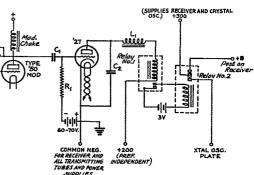
FIG. 1—BREAK-IN SYSTEM USED BY W9CJU
