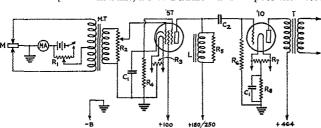
FIG. 1 - CIRCUIT USING THE 57 AS A HIGH-GAIN SPEECH **AMPLIFIER**
