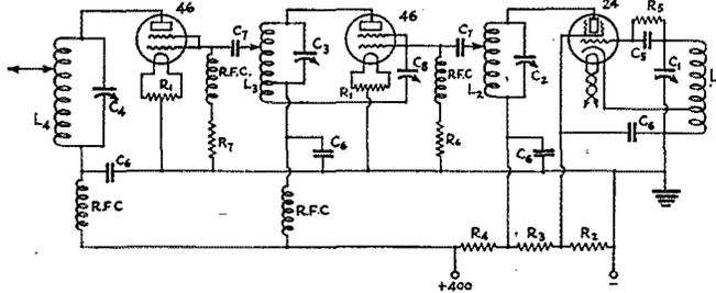
FIG. 3 — RECOMMENDED CIRCUIT FOR THREE-BAND OPERATION
