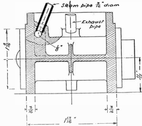
FIG. 54.—LONGITUDINAL SECTION, SHOWING THE CONNECTING LIVE STEAM PASSAGE.
