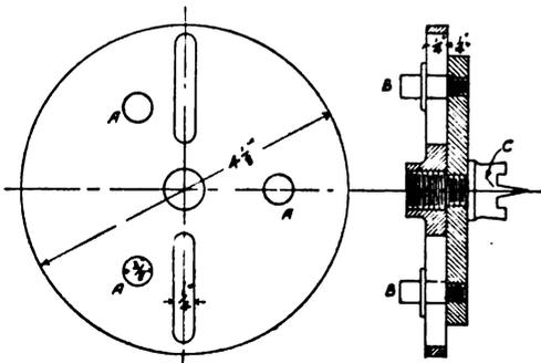
Fig. 1—Faceplate. Fig. 2—Section X. Y.
