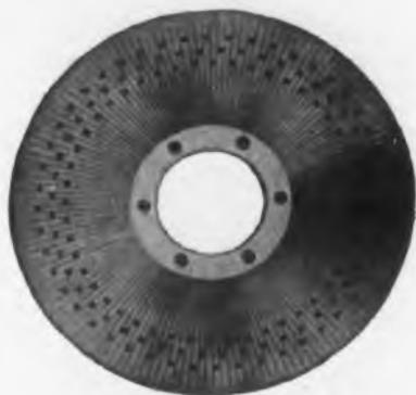
OPTICALLY FLAT CAPACITY COMMUTATOR
