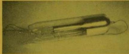
Fig. 1 An experimental triode.
