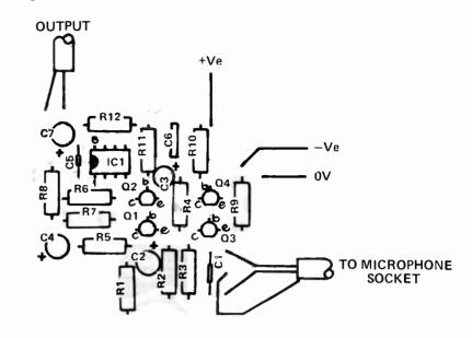
Fig. 3. Component overlay
