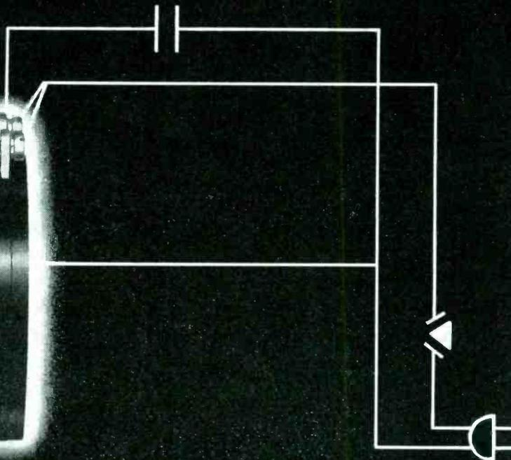
DRAG CUP MOTOR SIMPLE REVERSING CIRCUIT
