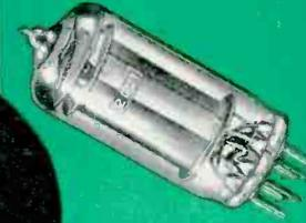
**2021 GRID CONTROLLED XENON RECTIFIER**
