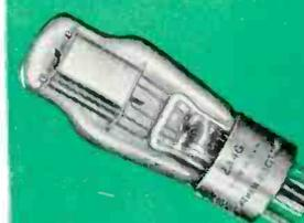
**2A46 GRID CONTROLLER ARGON RECTIFIER**
