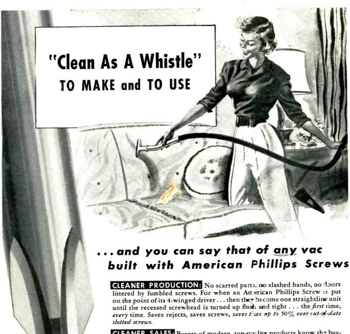
4-WINGED DRIVER CAN'T SLIP OUT OF PHILLIPS TAPERED RECESS
