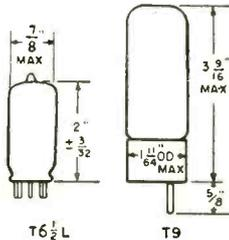
Maximum Wattage Dissipation: T6 $\frac{1}{2}$ L—5W. T9—10W.
