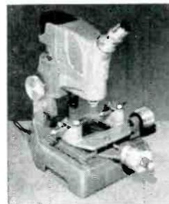
**NEW TOOLMAKER'S MEASURING MICROSCOPE**
